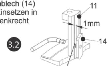
Achten Sie darauf, dass zwischen Bodenhalter (11) und Klemmblech (14) ca. min. 1mm Distanz besteht.
