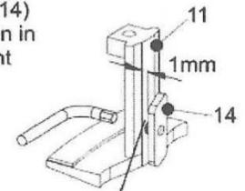
Achten Sie darauf, dass zwischen Bodenhalter (11) und Klemmblech (14) ca. min. 1mm Distanz besteht.
