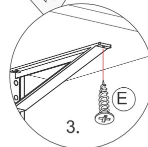
Anschließend die Böden vorne mit Spaxschraube **E** fixieren.
