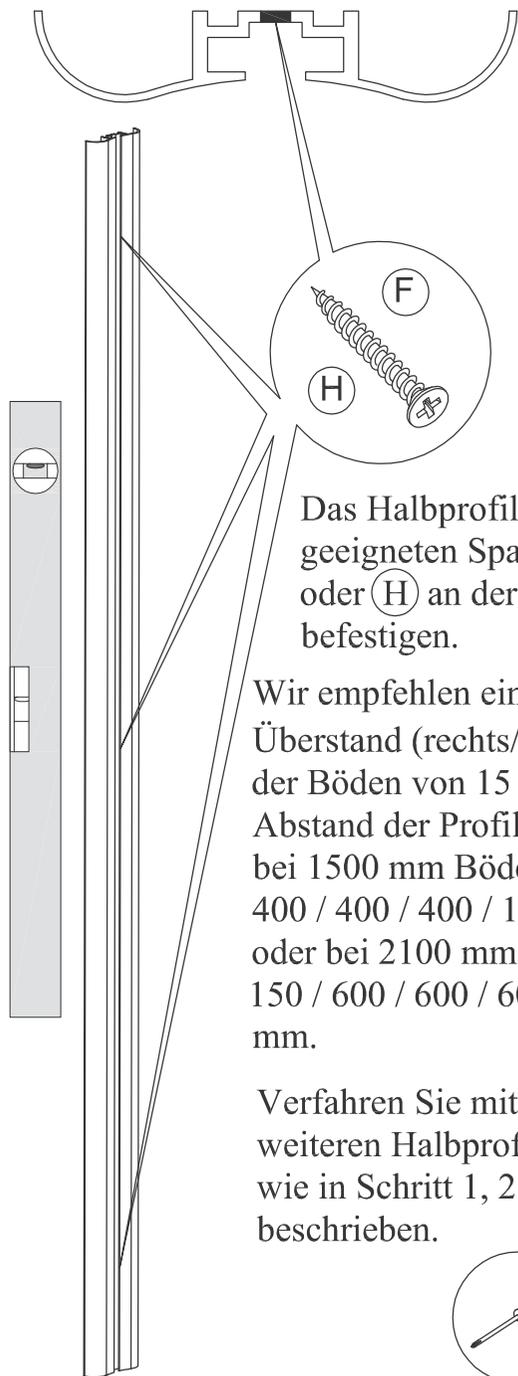
Das Halbprofil mit der geeigneten Spax (F) oder (H) an der Wand befestigen.
