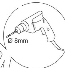
An den markierten Stellen mit einem 8mm Bohrer einsetzen und der Dübellänge entsprechend bohren. Anschließend die Dübel einsetzen. Bei einigen Wandtypen kann ein Spezialdübel erforderlich sein!
