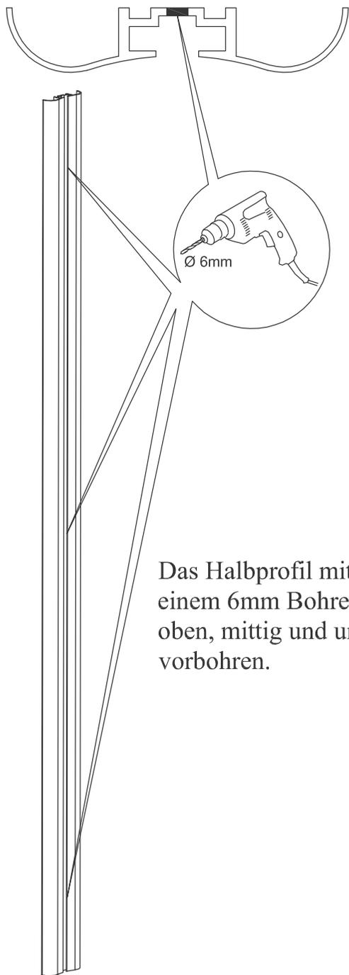
Das Halbprofil mit einem 6mm Bohrer oben, mittig und unten vorbohren.
