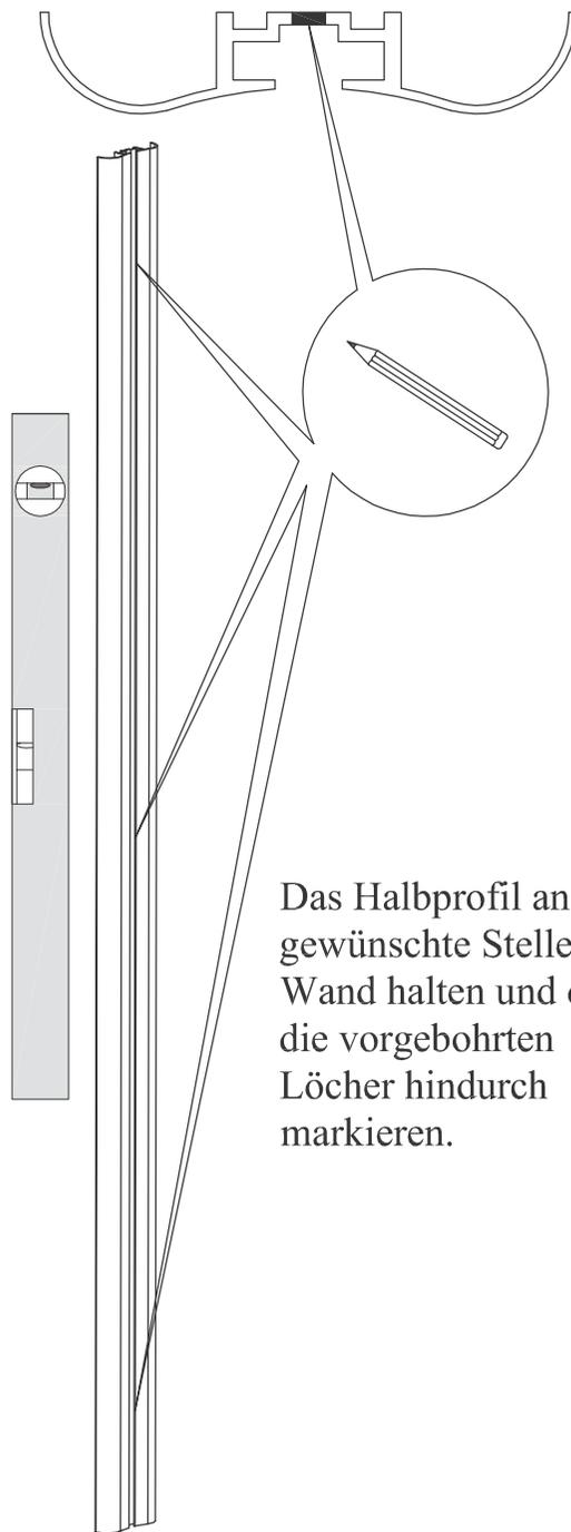
Das Halbprofil an die gewünschte Stelle der Wand halten und durch die vorgebohrten Löcher hindurch markieren.
